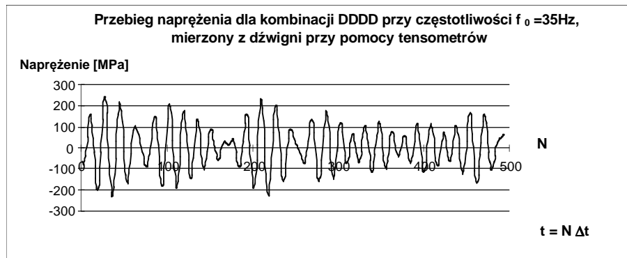
Rys. 5. Przebieg naprężenia wyznaczony eksperymentalnie na podstawie sygnału z tensometrów umieszczonych na dźwigni maszyny (okres próbkowania \Delta t = 0,003 [s])
