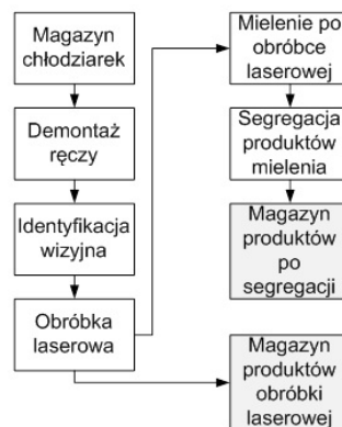
Rys. 2. Schemat blokowy przebiegu demontażu
