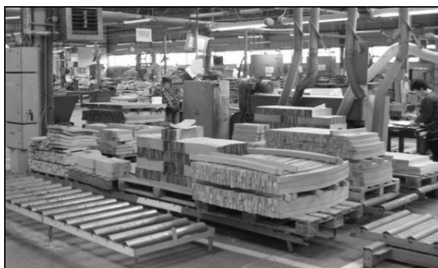
Rys. 2. Bufory produkcyjne stanu zastanego na rolkowym układzie transportowym
