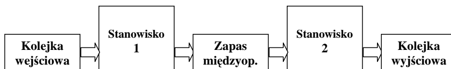
Rys. 4. Model symulacyjny potokowego procesu produkcyjnego z dwoma stanowiskami pracy
